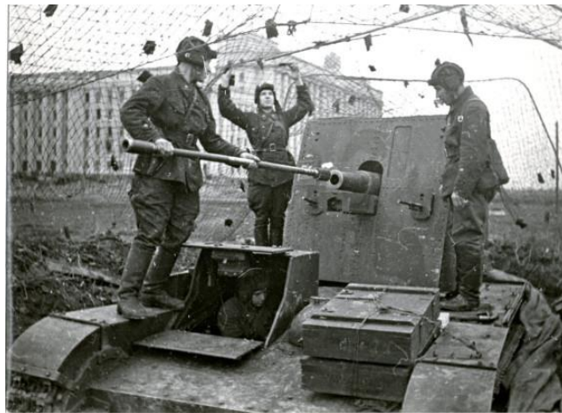
Рисунок 2 – СУ-26 с 76,2-мм орудием образца 1927 года в полуоткрытой рубке на базе танка Т-26
