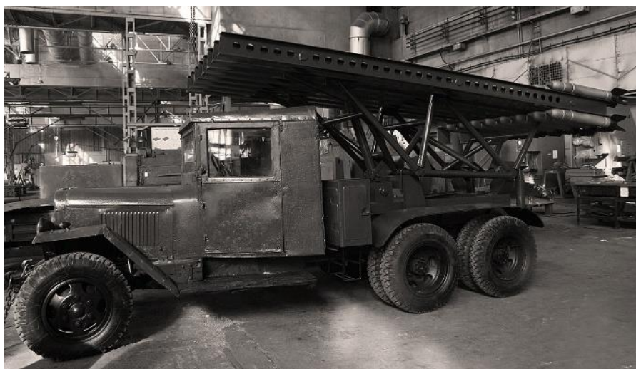
Рисунок 11 – В цехе завода имени Карла Маркса. Сентябрь 1941 г. БМ-13 на базе ЗИС-6
